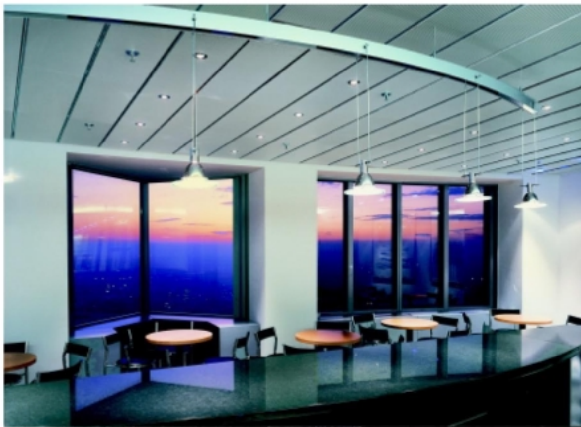
德国法兰克福国际博览会议中心顶楼 INDUL 条形出风口 P115-100 型，金属吊顶
